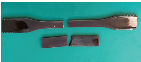
图 7 经拉伸试验和弯曲试验后的环氧树脂断裂样品
